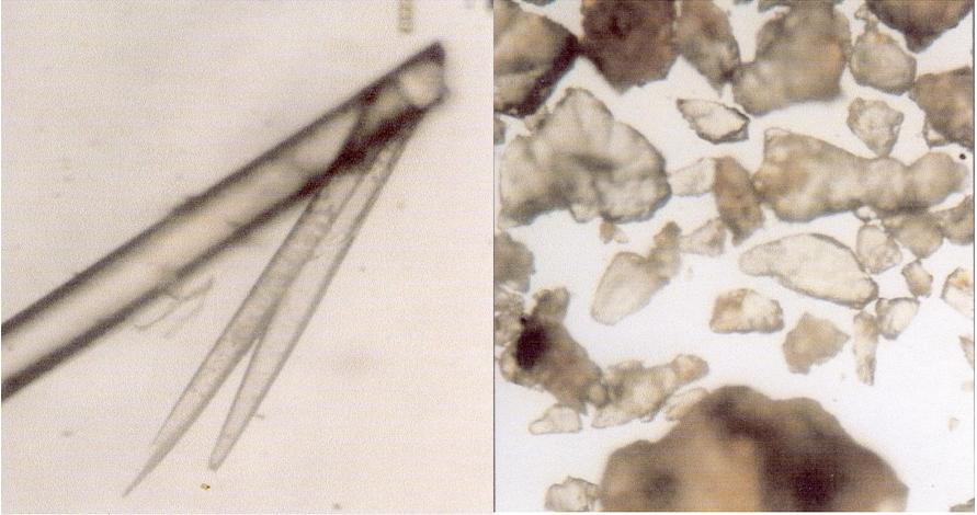
Vorhandene calcitige Ablagerungen ändern die Kristallisationsart zum Aragonit, wenn das Wasser aktiviert wird. Die Kalkschicht verliert dann an Härte und an Zusammenhalt und spült nach und nach fort.
